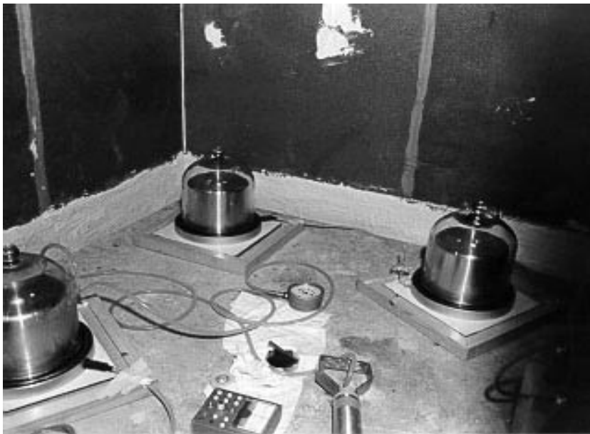
Trois sismomètres Wielandt-Streckeisen STS-1 en position de fonctionnement sur une station sismologique. Chaque sismomètre mesure environ 40 cm de diamètre.
