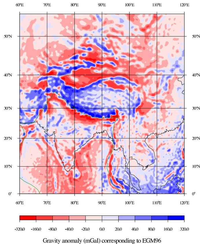
FIGURE 2 – Anomalies de pesanteur à l'air libre (mGal), c'est-à-dire corrigé de l'effet de l'altitude, dans la région du plateau tibétain (au centre).
