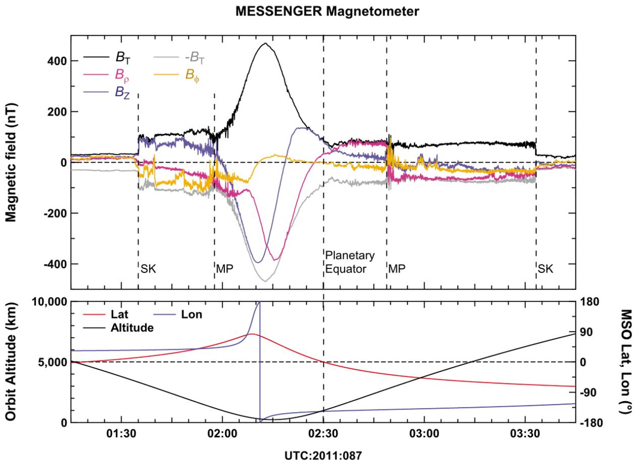
**Figure 1** – **En haut** : Composantes  $B_\rho$ ,  $B_Z$ ,  $B_\phi$ , et intensité  $B_T$  du champ magnétique mesuré par Messenger, en fonction du temps. **En bas** : position (latitude, longitude, altitude) de la sonde Messenger en fonction du temps. D'après Anderson *et al.* (2012).
